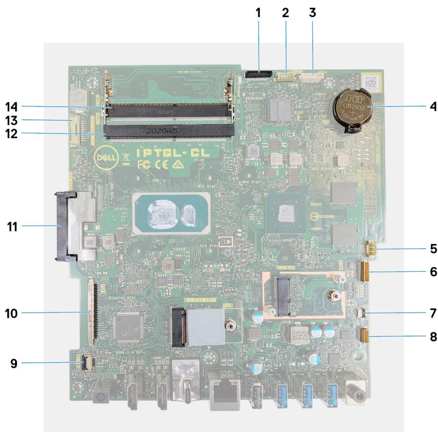
**图 2: 系统板连接器**
