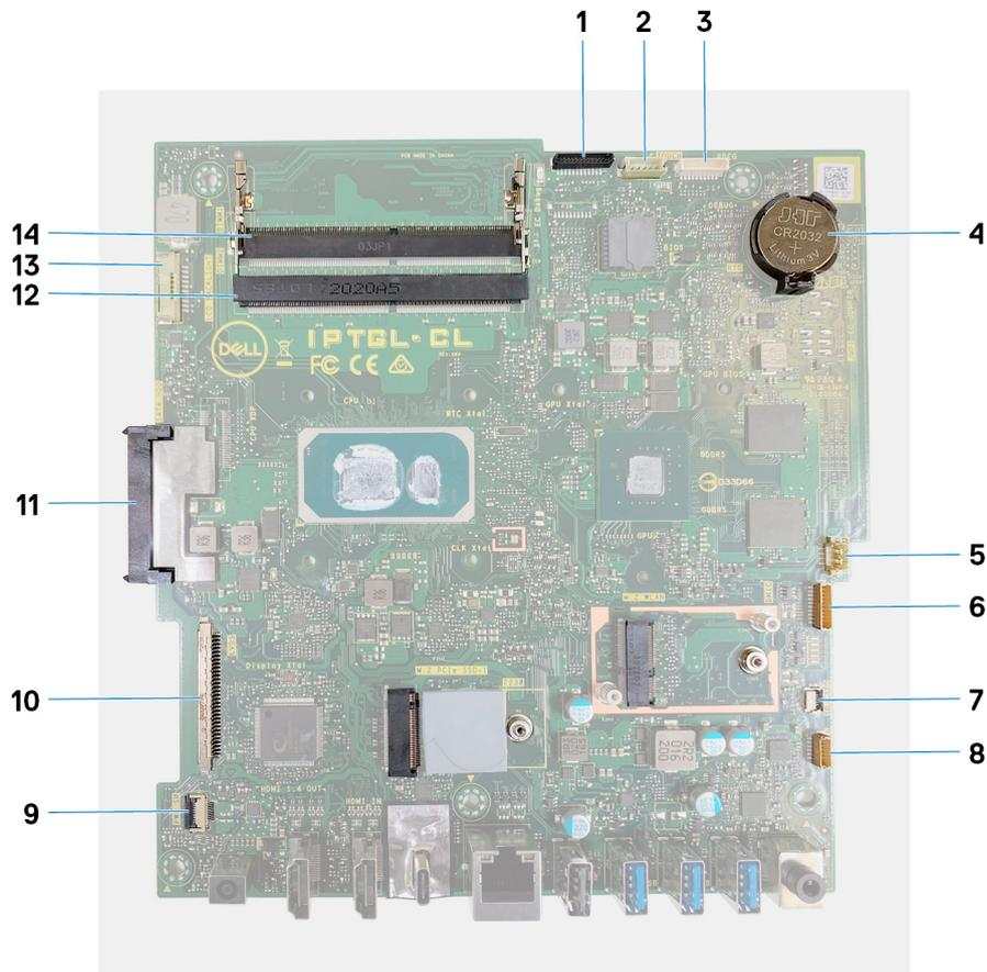
图 1: 系统板连接器
