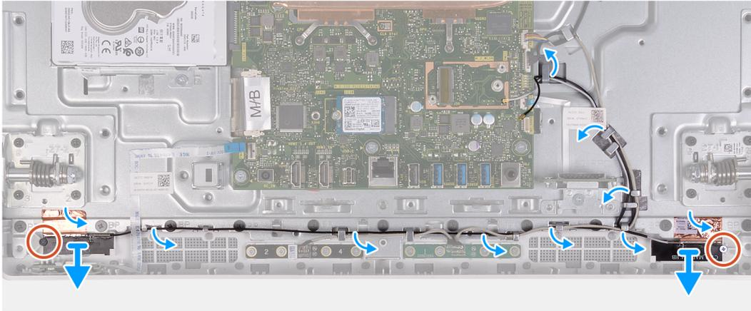
**注:** 记下天线线缆的布线方式，然后从布线导轨中取出天线线缆。此外，记下显示屏部件基座上刻制的天线模块位置：ANT-B（黑色）和 ANT-W（白色）。
